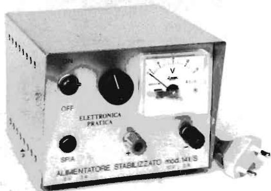
Di facilissima costruzione e di grande utilità nel laboratorio dilettantistico, l'alimentatore stabilizzato è dotato di una moderna protezione elettronica, che permette di tollerare ogni eventuale errore d'impiego del dispositivo, perché la massima corrente d'uscita viene limitata automaticamente in modo da proteggere l'alimentatore da eventuali cortocircuiti.
