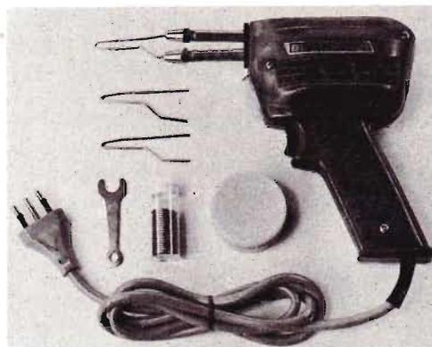
Il kit contiene: 1 saldatore istantaneo (220 V - 100 W) - 2 punte rame di ricambio - 1 scatola pasta saldante - 90 cm di stagno preparato in tubetto - 1 chiave per operazioni ricambio - punta saldatore
